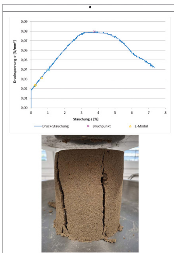
FÜW nach RAL GZ 507 - einaxiale Druckfestigkeit nach DIN EN ISO 17892-7 zum Nachweis der leichten Wiederaushubfähigkeit des Bodens
